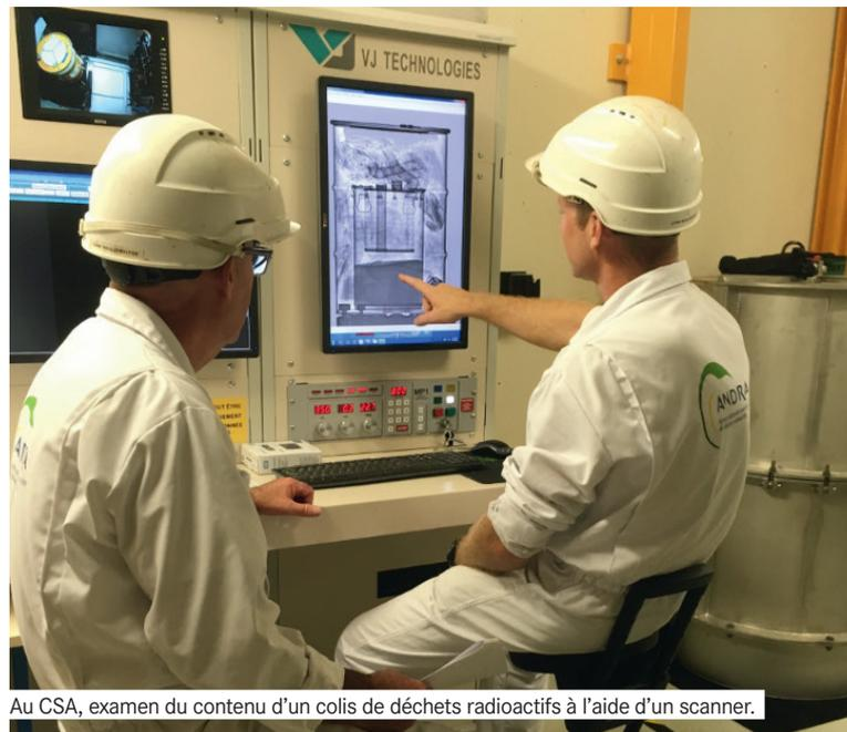
Au CSA, examen du contenu d'un colis de déchets radioactifs à l'aide d'un scanner.
