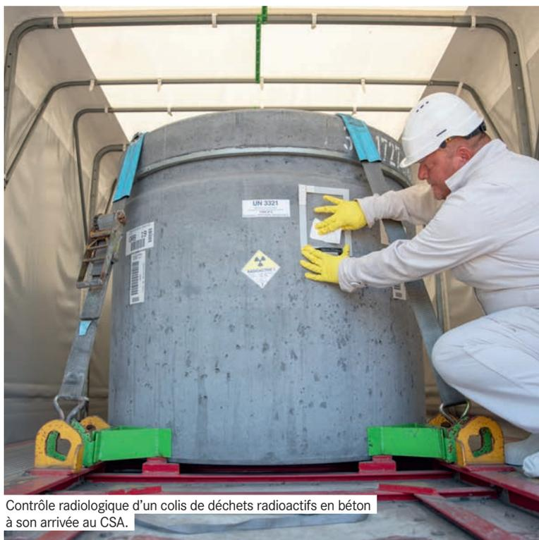
Contrôle radiologique d'un colis de déchets radioactifs en béton à son arrivée au CSA.
